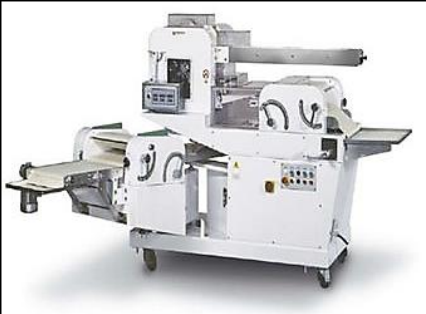
Formatrice meccanica per panificazione industriale 8000 pezzi / ora
