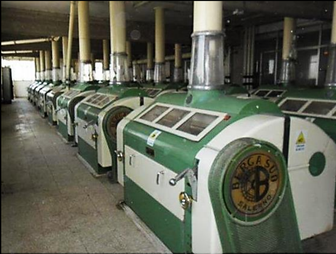
Molino a cilindri rotanti di capacità 24 tonnellate/giorno
