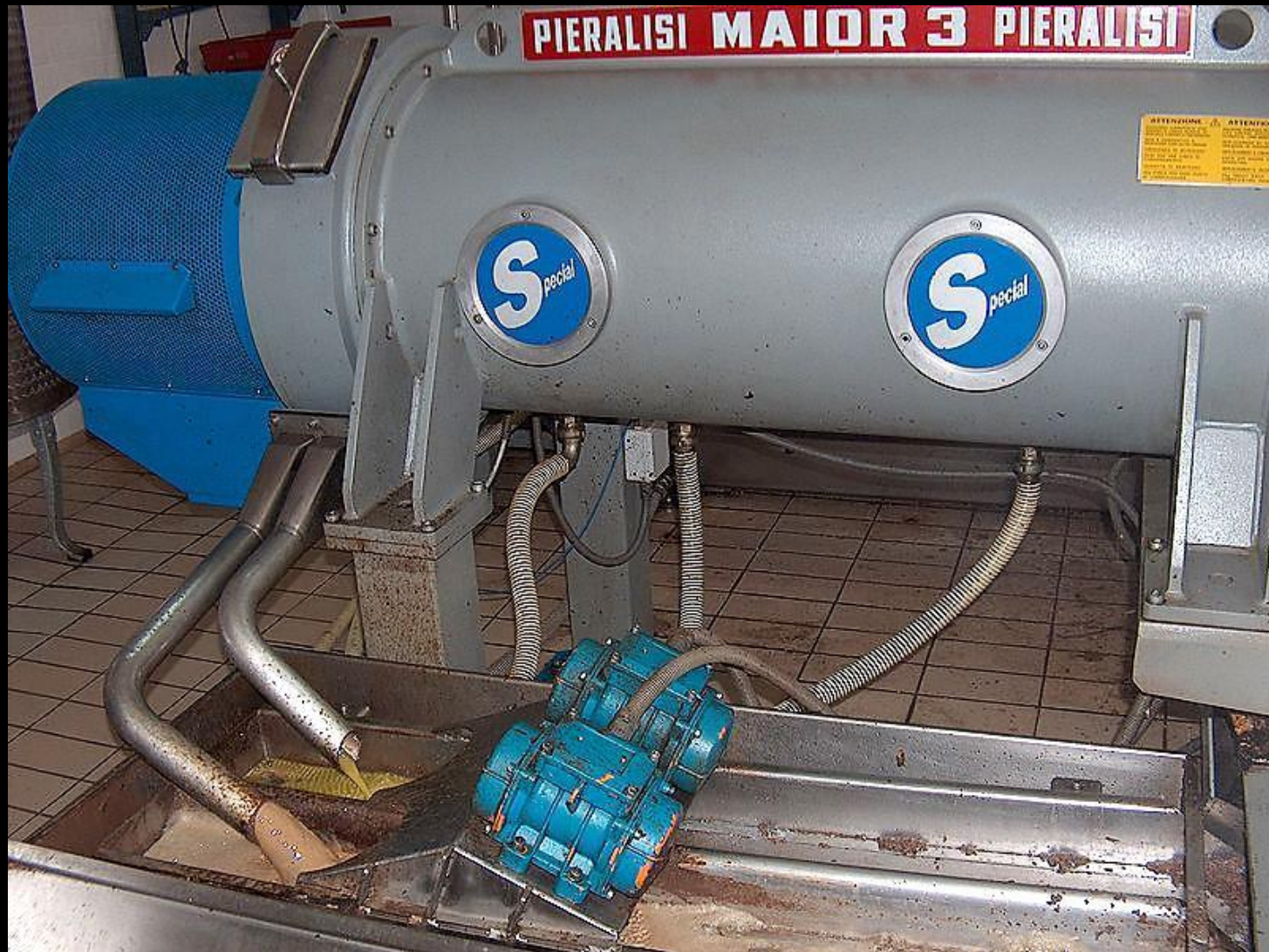
Decanter centrifugo a due fasi per estrazione di mosto di olio d'oliva e separazione della sansa
