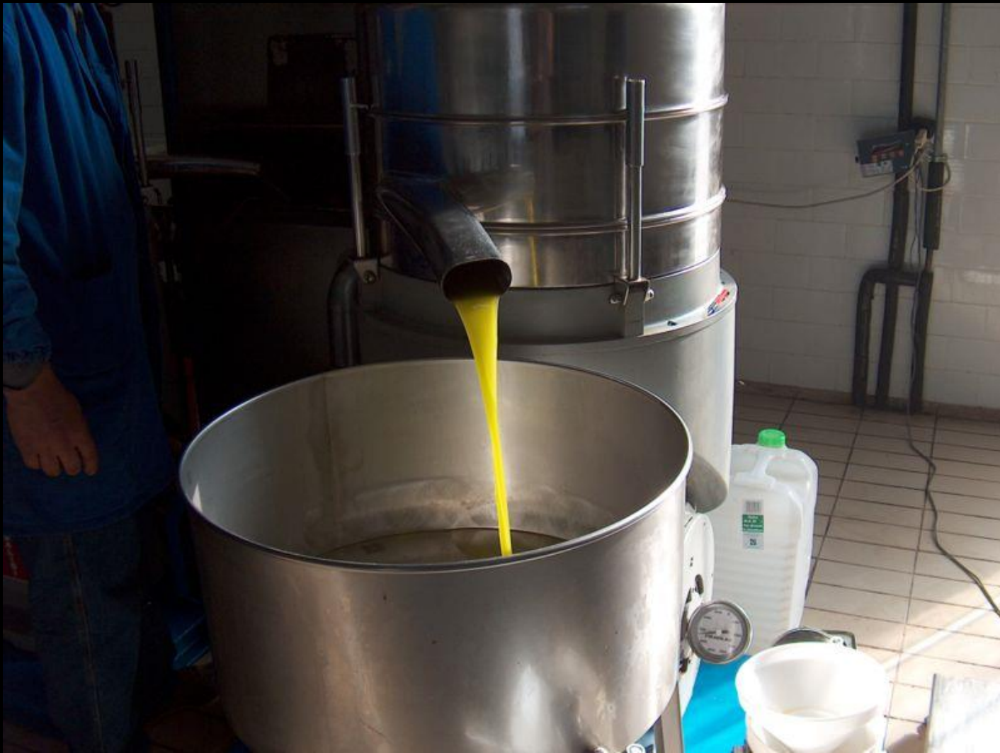
Centrifuga verticale per l'estrazione finale dell'olio di oliva dal mosto d'olio
